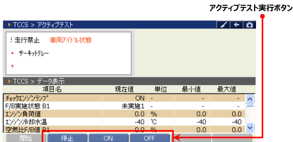
〈図：サーキットリレー アクティブテスト実行例〉
