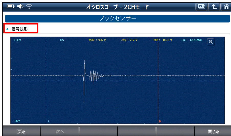
[ロックセンサーの波形分析ガイドと参照波形に関する説明画面]
