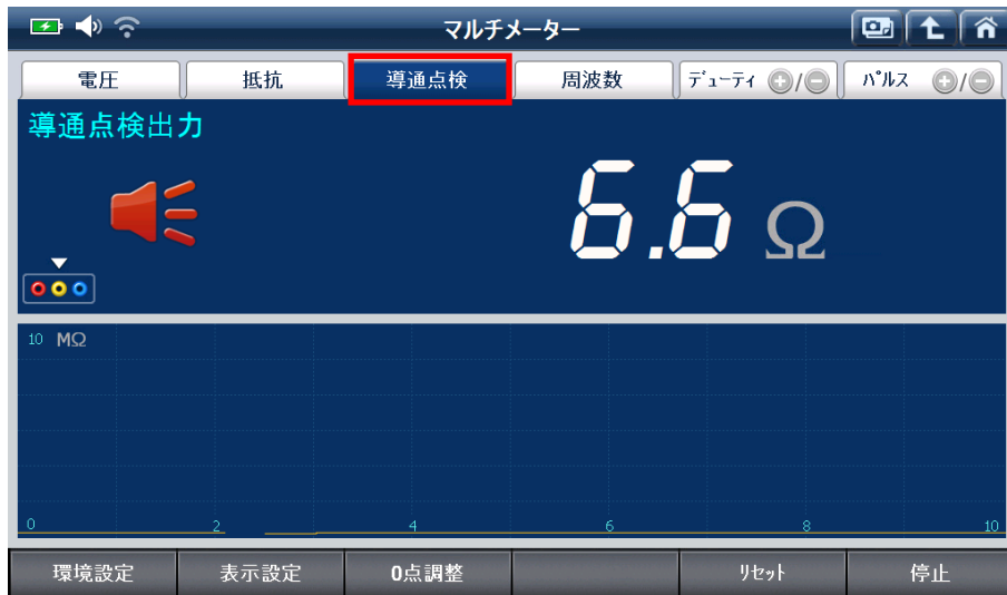
[導通点検 - 導通 / ブザーON]
