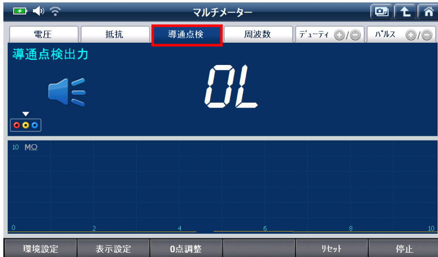
[導通点検 - 断線 / ブザーOFF]
