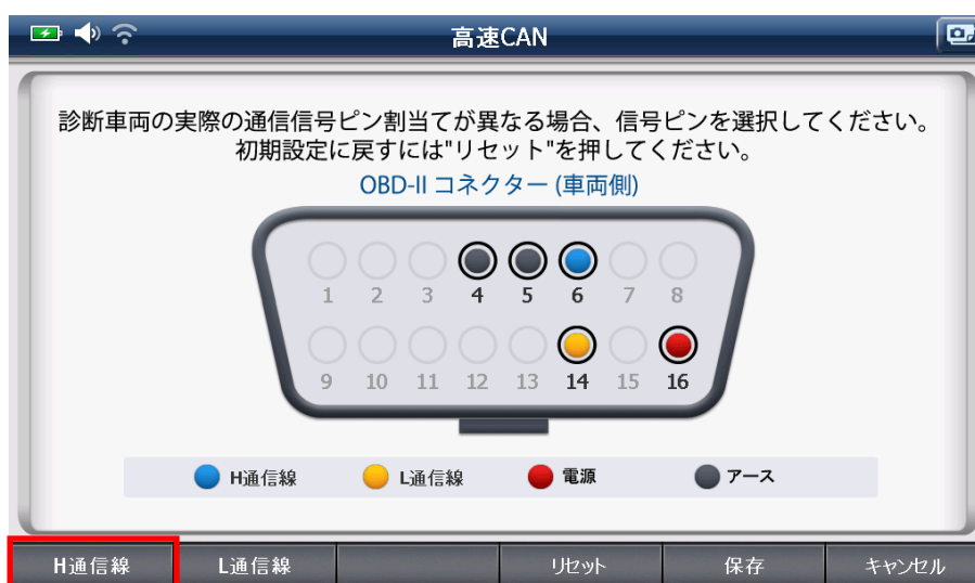
[高速 CAN - 設定 - H 通信線を選択する]
