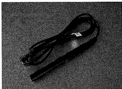
〔↑第36図 点火系用の高圧測定プローブ〕
