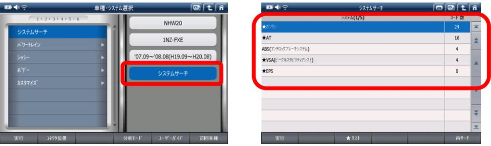
システムサーチを選択すると、診断可能なシステム一覧とそれぞれのシステムに故障コード（DTC）が何個あるが表示されます
