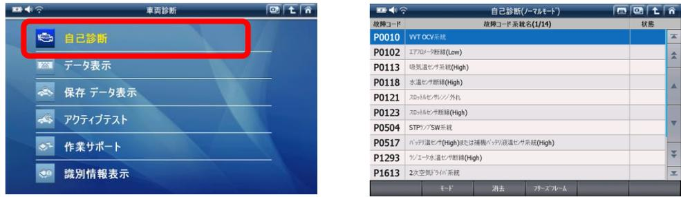
診断したいシステム（エンジン・AT/CVT・ABSなど）を選択し、「自己診断」を選択すると、故障コード/故障コード系統名が一覧で表示されます
