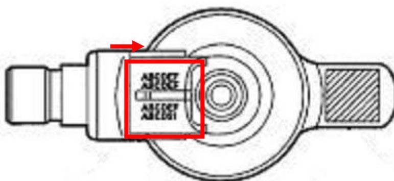
矢印の方向に読み、インジェクターIDコード(24桁)は赤枠内にIDコードが刻印されています。
