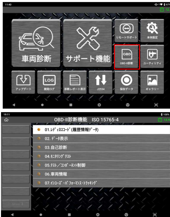
CAN バスタイプの車両の OBD-II メニュー例
