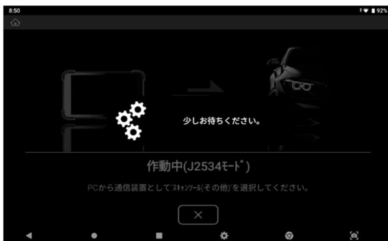
4. 「作動中」と表示されたら、J2534 で動かすソフトをインストールしている PC と本機を USB で接続してください。接続するポートは、Z 本体の “タイプ C”（J2534 と書かれているポート） を使用してください。
