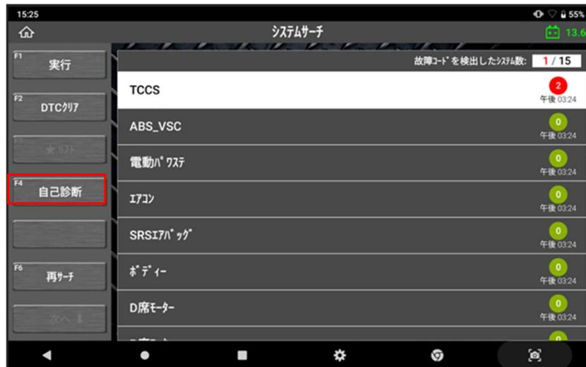
[システムサーチ]完了後、[自己診断]を選択すると検出されたシステムと故障コードが一覧で表示され、右上の[レポート作成]ボタンが有効になります。
