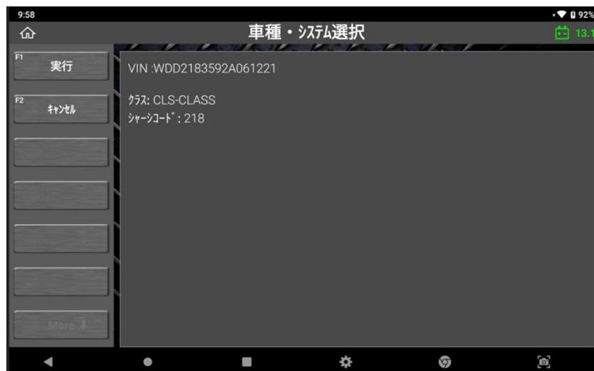
※診断をおこなう車両が CAN 通信プロトコルを搭載していない場合など、自動選択が機能しない可能性があります。そのような場合は手動で車種等を選択してください。
